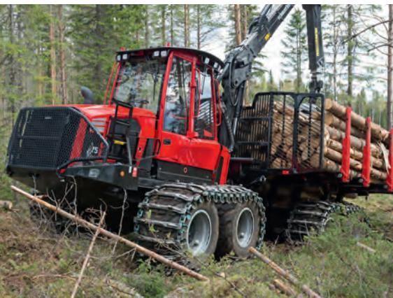
Специальное решение (гидро-статической)трансмиссии с базовым тяговым усилием 214 кН и ее уникально слаженное взаимодействие с системой управления и двигателем обеспечивают высочайшую эффективность.
