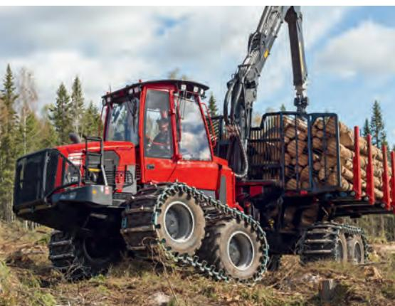
Оптимально сбалансированная тандемная тележка портального типа Komatsu Comfort обеспечивает превосходные дорожный просвет и проходимость машины.
